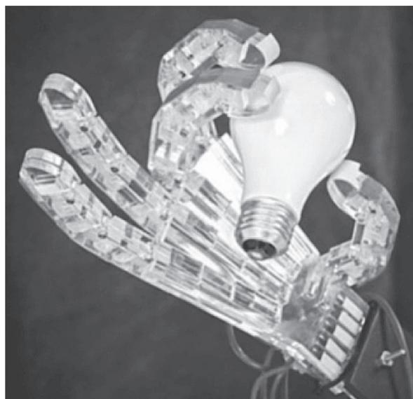
Рис. 1. Манипулятор типа «рука» на основе пневматических пальцев
