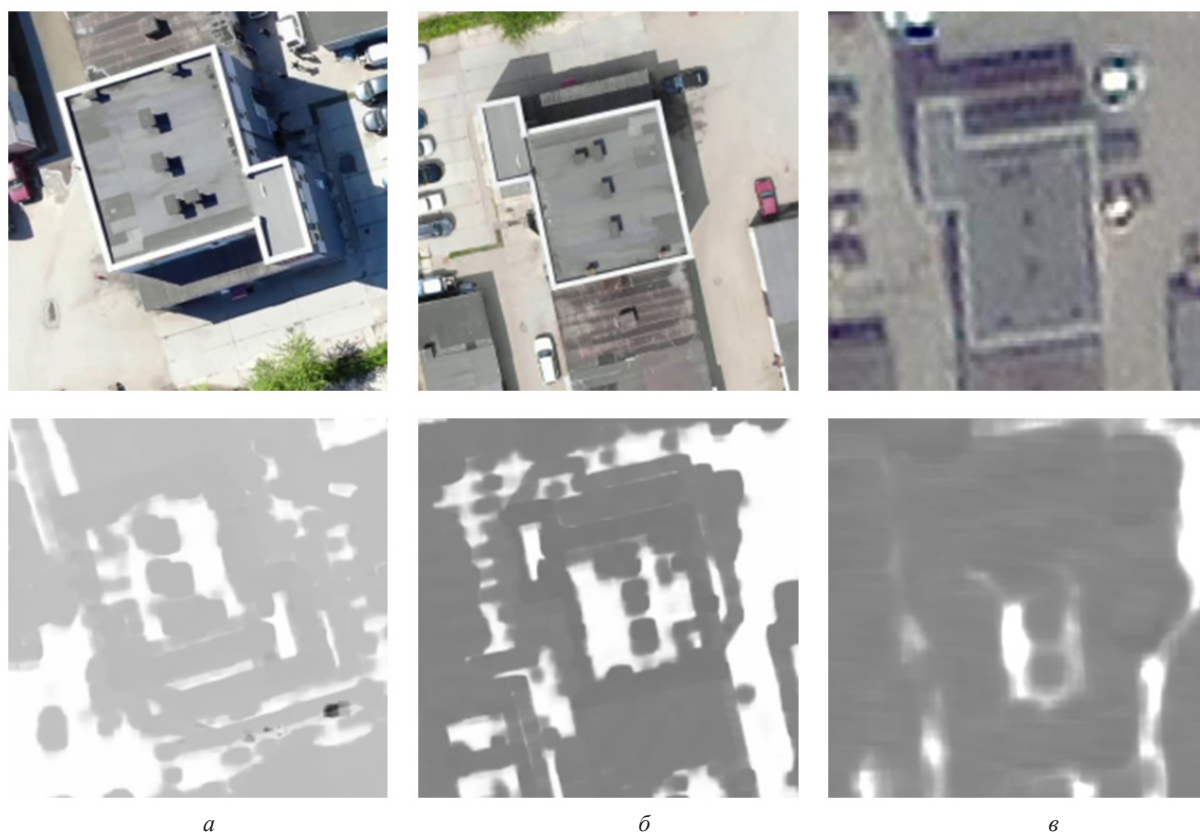
Рисунок 7. Изображения ННО и соответствующие им ЭМ: а – та же траектория полета; б – обработанный кадр ТМ; в – спутниковый снимок
