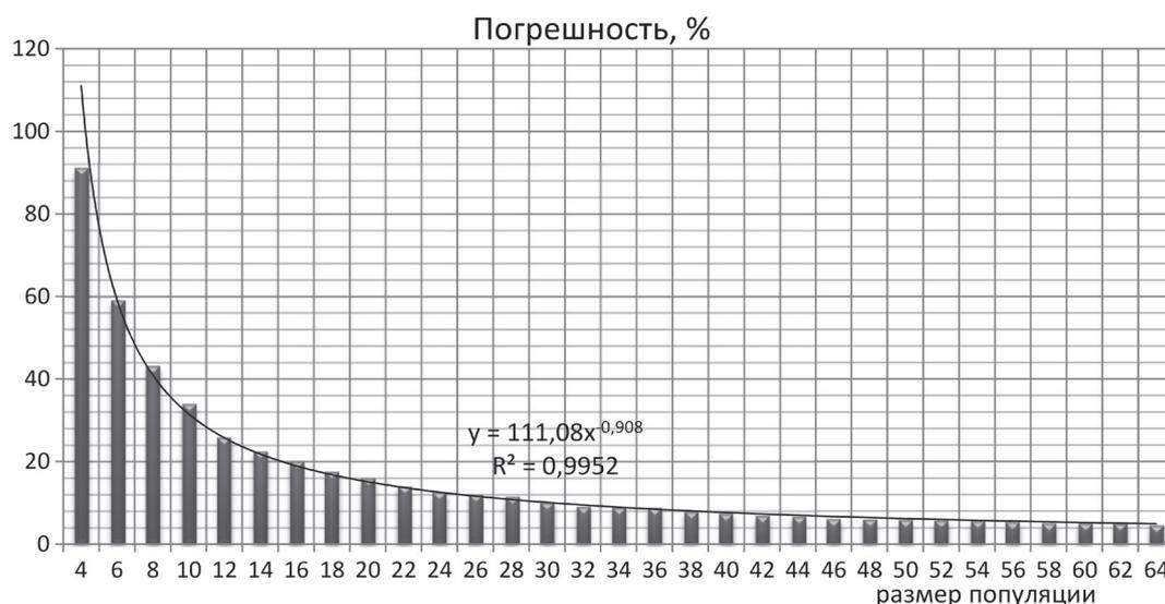
Рисунок 1. - Зависимость точности результата от размера популяции
