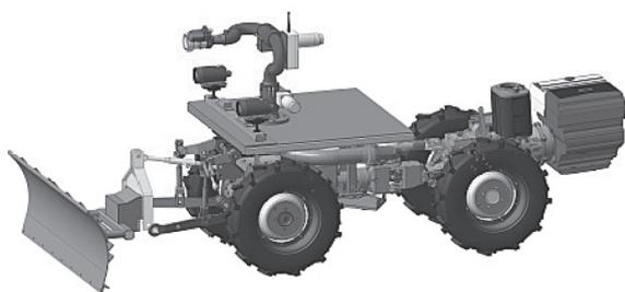
Рисунок 1. - Общий вид робототехнического комплекса на базе шасси «Беларус 132»
