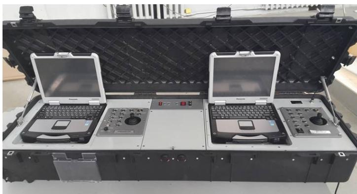
Рис. 1. Внешний вид наземного пункта управления
