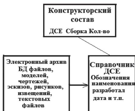
Рис. 2. Упрощенная структура БД большинства PDM
