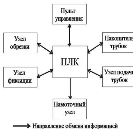
Рис. 1. Структурная схема системы управления устройством автоматической намотки битумно-полимерных лент на бобины
