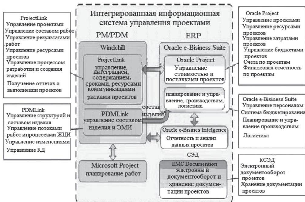
Рис. 1. Интегрированная информационная система РКК «Энергия»
