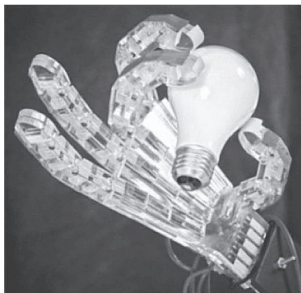
Рис. 1. Манипулятор типа «рука» на основе пневматических пальцев
