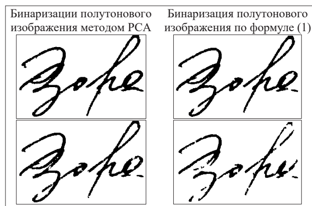
Рисунок 6. Результаты преобразования цветного изображения (рисунок 5) в полутоновое с последующей бинаризацией: верхний ряд – методом Капура, нижний – методом Отсу
