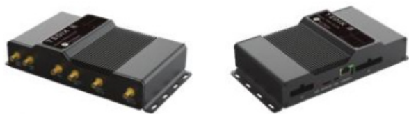
Рисунок 21. Бортовой модуль LTE-V2X (TEDIX)
