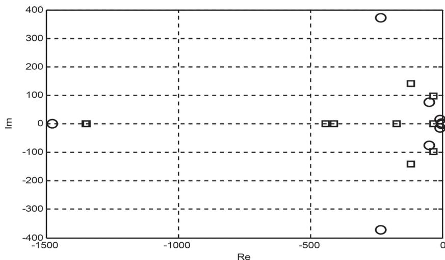
Рис. 2. Корни характеристических полиномов контуров регулирования при  $\varepsilon = 0,2$
