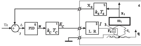
Рис. 1. Схема управляемой амортизированной массы: 1 – усилитель ( $k_c$  – коэффициент усиления,  $T_c$  – постоянная времени); 2 – катушка; 3 – амортизатор с MR жидкостью; 4 – амортизированная масса; 5 – датчик ( $k_s$  – коэффициент усиления,  $T_s$  – постоянная времени); 6 – PID-регулятор; 7 – элемент сравнения
