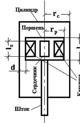
Рис. 2. Схема амортизатора
