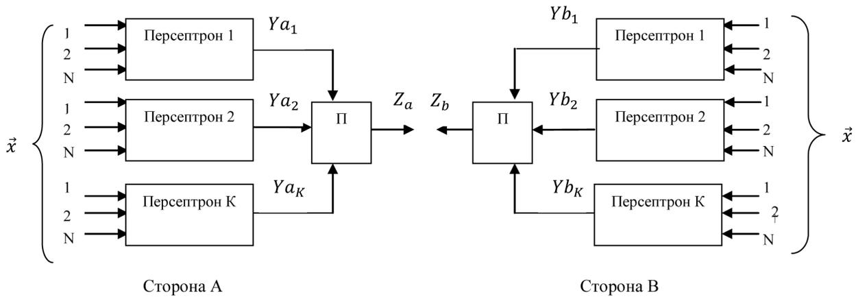
Рис. 1. Синхронизируемые ИНС.
